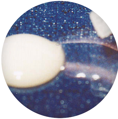
Une goutte d'eau est placée à côté de la résine Embrace non polymérisée.
