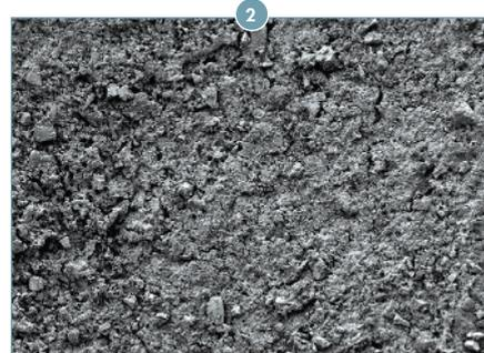
MEB\* muestra la superficie de porcelana vidriada DESPUÉS 1 minuto de tratamiento con Pulpdent Porcelain Etch Gel. Note las marcas microscópicas en la superficie de porcelana.
